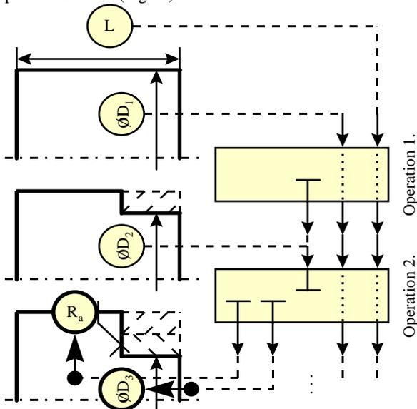
Fig. 1 "Internal" parameters ( $D_2$ ) and end-product parameters ( $R_a$ ,  $D_3$ ).
